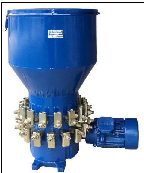
Elektromotorna viševoda pumpa za podmazivanje mašina i uljima koristi se kod višelinjskih centralnih sistema za podmazivanje. Promenljivog je protoka sa mogućnošću u nezavisne regulacije protoka maziva od minimuma do maksimuma svakog izlaza. Po potrebi protok na odredenom izlazu može da se isključi. Broj izlaza pumpe bira se pri narušivanju i kreće se od jednog do trideset. Rezervoar u standardnoj verziji je zapremine  $30 \text{ dm}^3$  a po potrebi može i drugačiji.
