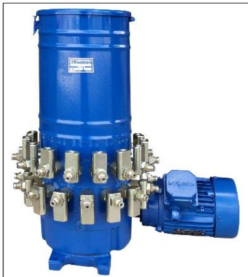
Elektromotorna viševoda pumpa za podmazivanje mašina i uljima koristi se kod višelinjskih centralnih sistema za podmazivanje. Promenljivog je protoka sa mogućnošću u nezavisne regulacije protoka maziva od minimuma do maksimuma svakog izlaza. Po potrebi protok na određenom izlazu može da se isključi. Broj izlaza pumpe bira se pri narušivanju i kreće se od jednog do trideset. Rezervoar u standardnoj verziji je zapremine  $10 \text{ dm}^3$  a po potrebi može i drugačiji.
